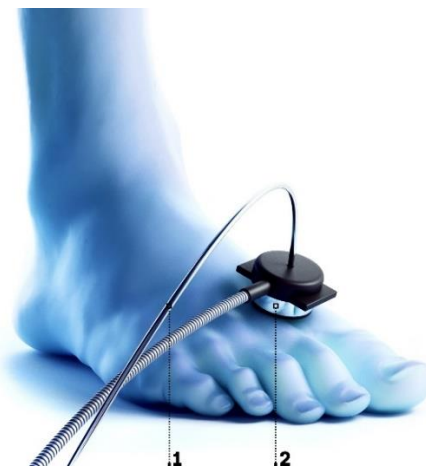
Рисунок 3 – Расположение зонда для исследований: 1 – волоконно-оптический зонд; 2 – приспособление для тепловой и холодной проб (содержит элемент Пельтье с водяным охлаждением)
