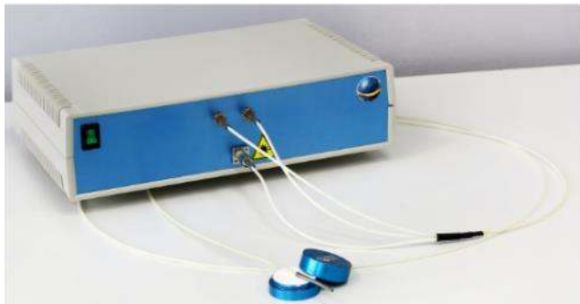
Рисунок 2 – Внешний вид устройства для диагностики (а) и геометрическая конфигурация торца волоконно-оптического зонда (б)
