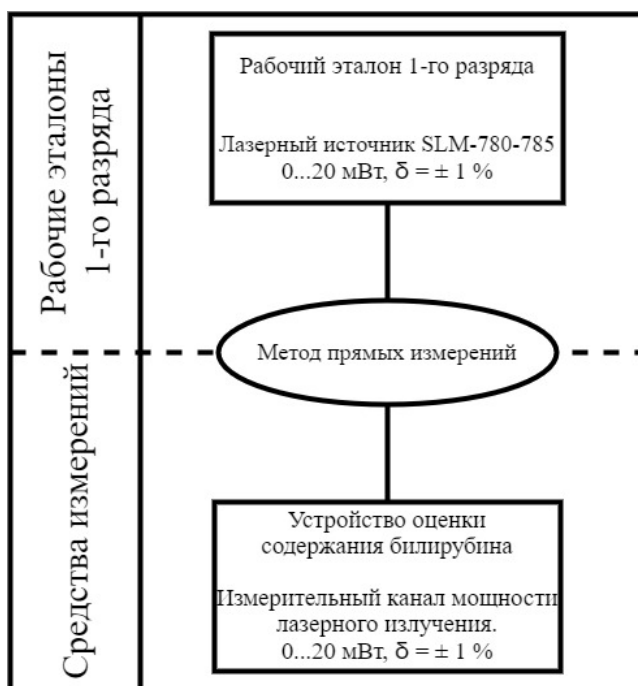
Рисунок 3 – Локальная поверочная схема КТС канала измерения мощности.
