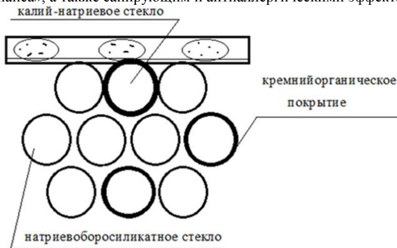
Рисунок 2 – Структура смеси микростеклофер во внутреннем чехле ортопедического средства
