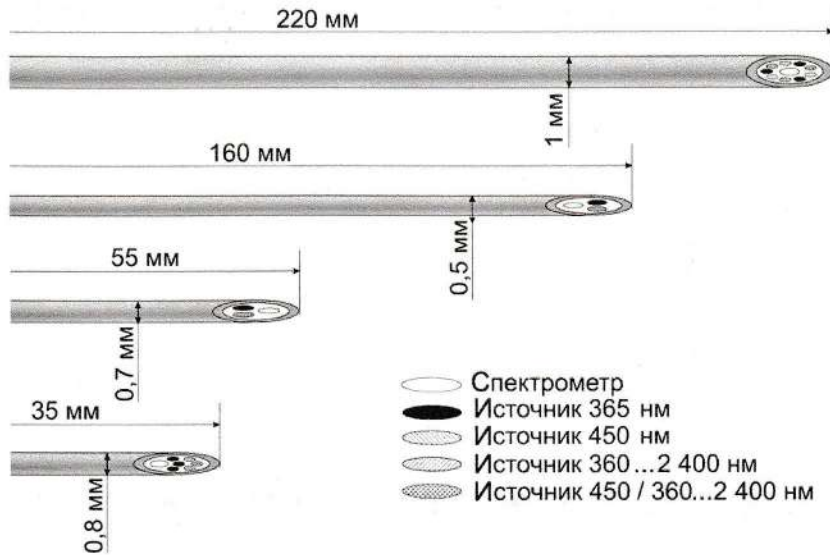
Рис. 2. Различные типы тонкоигольных оптоволоконных зондов
