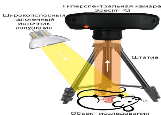
Рисунок 1 – Экспериментальная система ГВ
