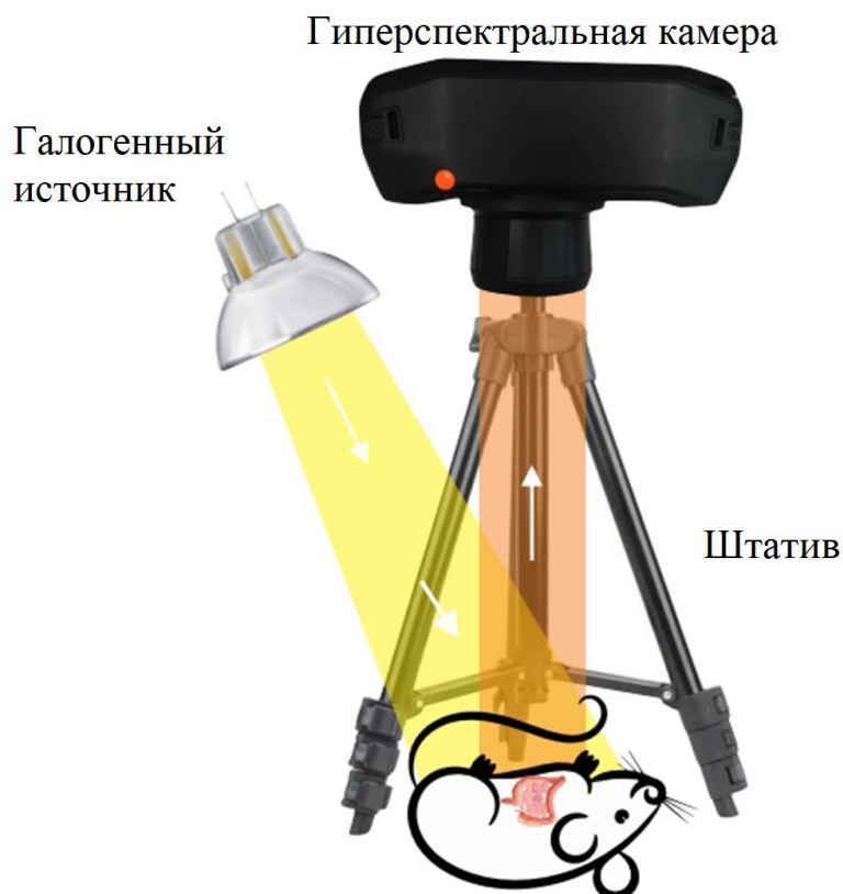
Рис. 1. Система гиперспектральной визуализации
