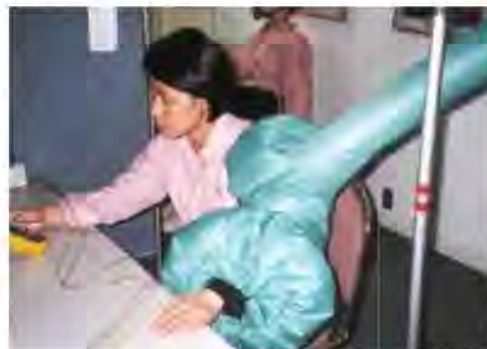
Рисунок 2 – Моделирование охлаждающего воздействия на поверхности элемента тела по технологии «Air sleeve»
