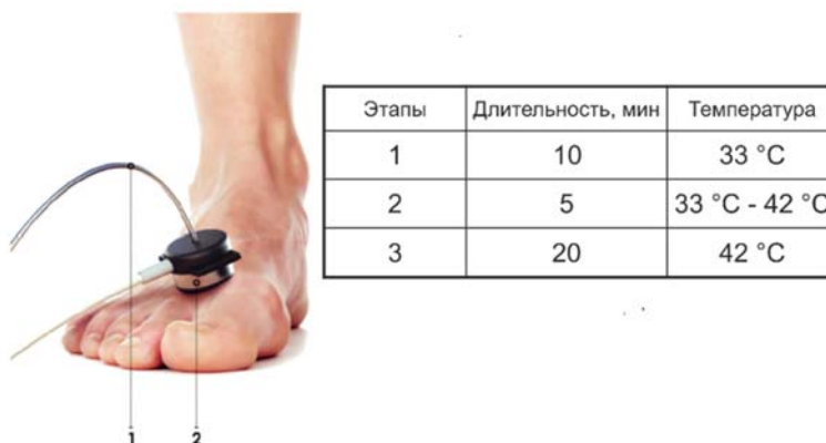
Рисунок 2 – Зона интереса и протокол исследования: 1 – оптическое волокно; 2 – нагревательный элемент.
