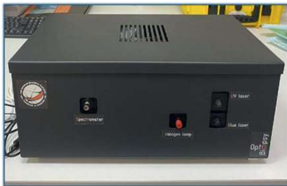
Рис. 2. Устройство флуоресцентно-отражательной спектроскопии (А) и тонкоигольный оптоволоконный зонд (Б)
