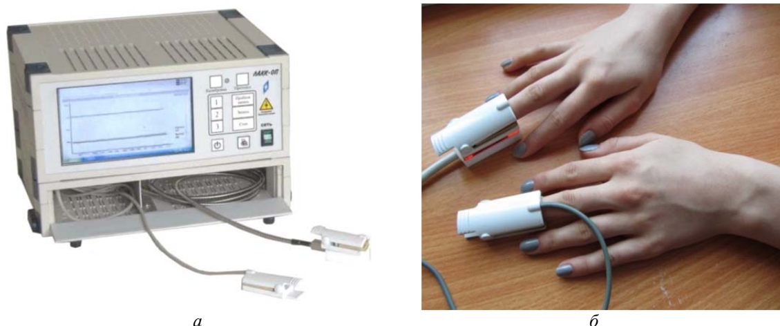
Рисунок 1 – Внешний вид лазерного анализатора микроциркуляции крови для врача общей практики «ЛАКК–ОП» (а) и расположение оптических датчиков на пальцах рук добровольца во время проведения исследований (б)
