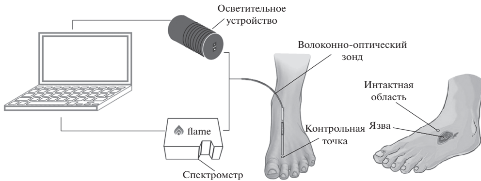
Рис. 1. Схема экспериментальной установки для исследования спектров диффузного отражения кожи.
