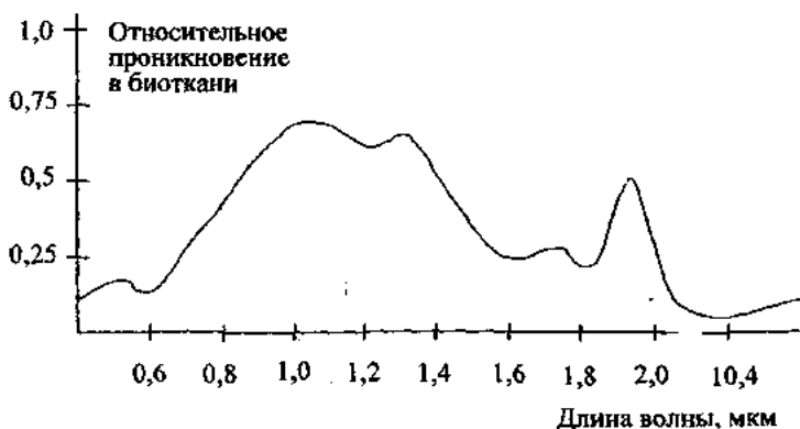
Рис. 14. Глубина относительного проникновения излучения в биоткань в зависимости от длины световой волны
